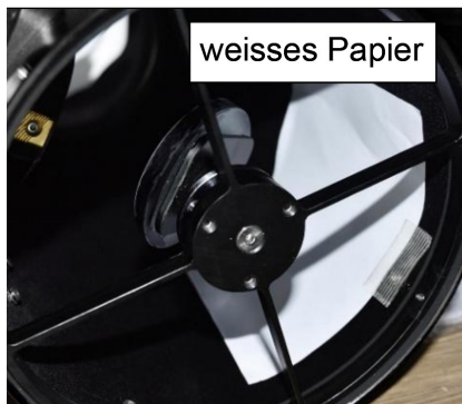
Papier hinter dem Fangspiegel an der Tubuswand
